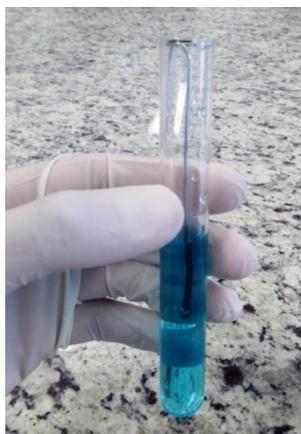
Figura 13: Clipe em contato com o sulfato de cobre
